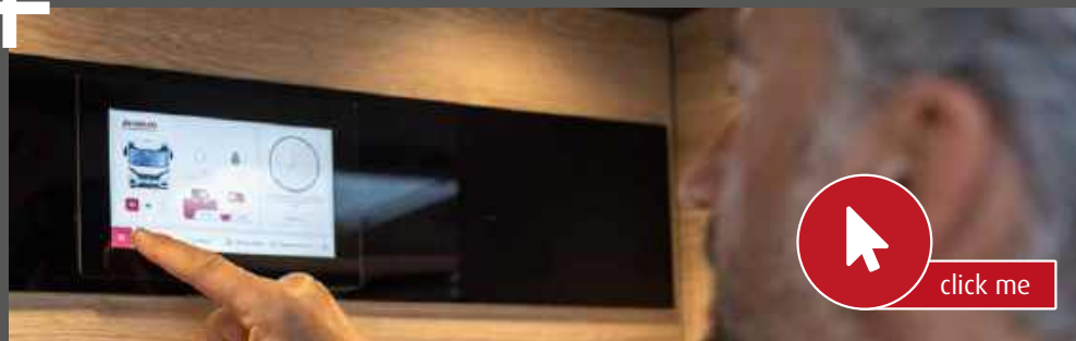
Dethleffs Connect: het digitale controlecentrum! je kunt belangrijke voertuiggegevens bekijken en relevante verbruikers zoals de koelkast, verwarming of airco bedienen via een touchdisplay in de woonruimte of via de smartphone-app
