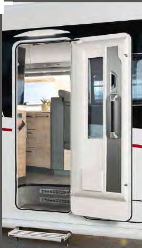
70 cm brede deur met raam, centrale deurvergrendeling en elektrische sluishulp
