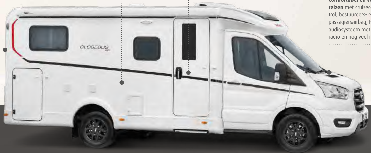
Dak, achterzijde en zijwanden van sterk GFK-materiaal.
