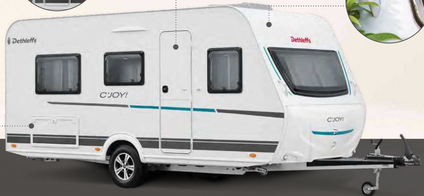
De voor- en achterzijde en het dak zijn gemaakt van hagelbestendig GFK-materiaal
